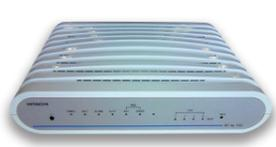
VoIPゲートウェイ機能 (音声(IP)に変換する機能) とルータ機能を備えた装置です。
