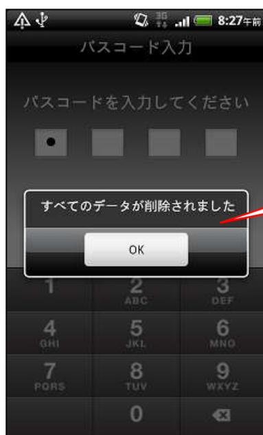
上記「データの削除」を「ON」にした場合、パスコード入力を 10 回失敗すると、右図のように、データ削除のメッセージが出て、データが削除されます。
