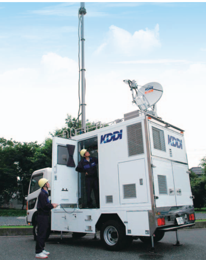
衛星通信機能を備えた車載型無線基地局。災害時などの通信ネットワークの確保に力を発揮する。
