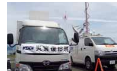
被災地の通信インフラを確保する移動電源車と車載型無線基地局
