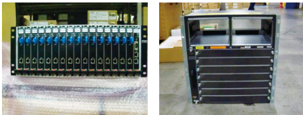
一旦、資材管理センターに保管された加入者通信網の局側終端装置(左)とデータ転送装置用の筐体(右)
