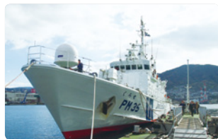
巡視船くろせの船首部分に衛星アンテナ(円筒カバー内)を設置 出典:災害時における携帯電話基地局の船上開設に向けた調査検討会
