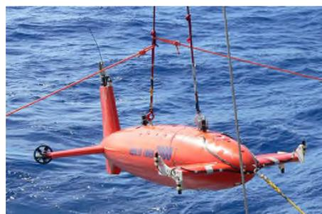
翼にハイドロフォンアレイを装着した水中ロボット「AE2000」
