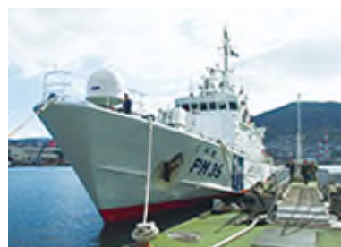
巡視船くろせの船首部分に衛星アンテナ（円筒カバー内）を設置 出典：災害時における携帯電話基地局の船上開設に向けた調査検討会
