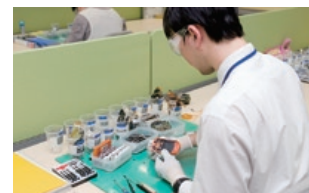
KDDIチャレンジドの事業のひとつ、リサイクルのための携帯電話分解の作業
