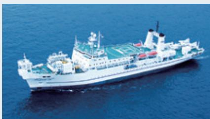
海底ケーブルの敷設や保守を行うケーブル・シップ「KDDI OCEAN LINK」(9510t、全長133.5m、全幅19.6m)
