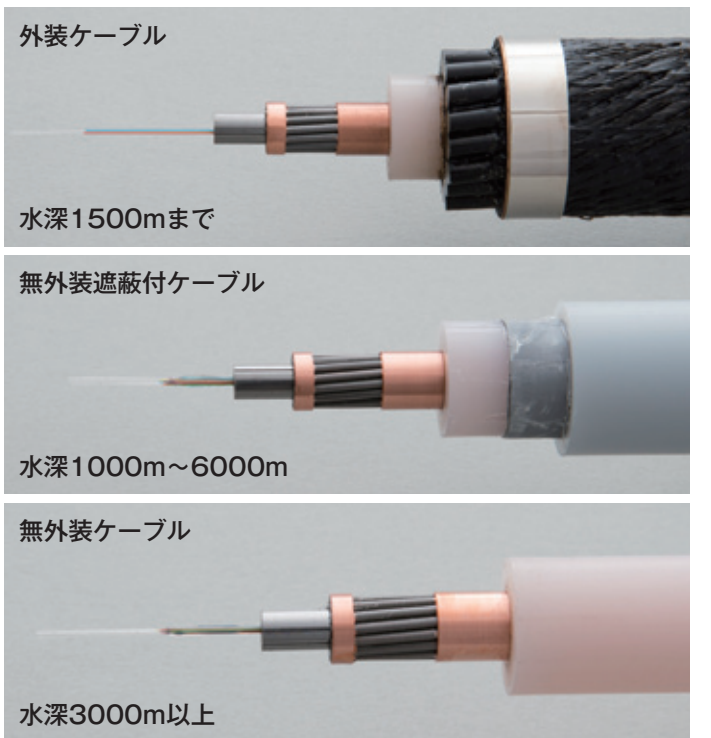
光海底ケーブルは樹脂や金属で光ファイバーを保護し、敷設される場所の水深や海底の地質に応じ、鋼線などで強化されたものが用いられる。漁具などで障害のリスクの高い浅海部では太い外装ケーブルが、リスクの小さい深海部では細い無外装ケーブルが使われる。写真は、SJCで使われているケーブル
