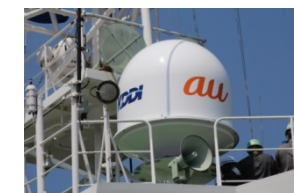
巡視船「さつま」のブリッジ上に設置された実証試験用の携帯電話基地局
